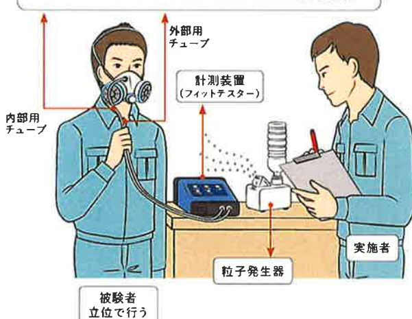
2本のチューブでマスク内部と外部の粉じん量を測定
