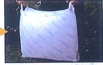
約2分後に約20kgの土嚢が完成
