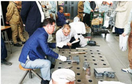
使い試験体を仮組後、受検番号を刻印してから本溶接に入った。溶接終了後、立会検定員が外観検査を行い、後日超音波探傷検査、マクロ試験を行って最終判定が下される予定である。
